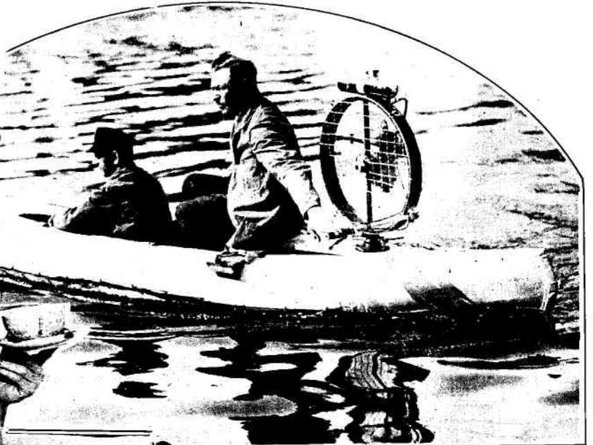
Un ingeniero alemán ha construido este tipo de bote con un minúsculo propulsor de un cilindro. La hélice que lo impulsa permite también dirigirlo en todos los sentidos. La velocidad alcanzada por este sistema es considerable.
